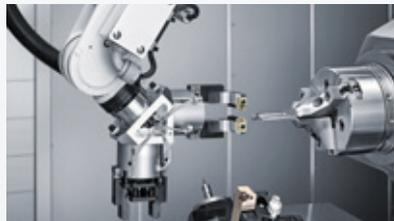
加工ワークの取外し、素材の取付け
