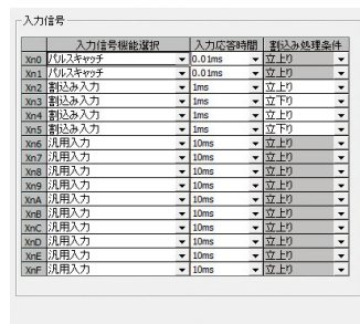
【CPU内蔵I/O機能 パラメータ設定例】 パルスキャッチ:0.01ms(入力応答時間) 割り込み入力:1ms(入力応答時間)
