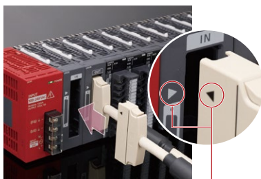
印にあわせて、ケーブルを接続
