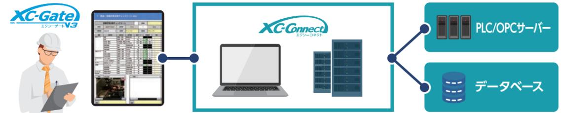
XC-Connectは、パソコンやサーバーにインストールし、通信可能なPLCや基幹システムのデータベースとXC-Gate.V3とのデータ連携設定を行うことができる無料ソフトです。XC-Connectを経由し、XC-Gate.V3の帳票への外部データ表示、XC-Gate.V3に保存された実績データの出力を行うことができます。
