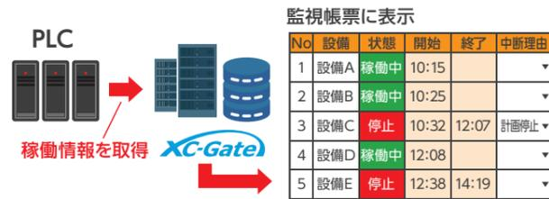
設備を制御するPLCから、機械が持つ正確なデータを取得して現場の稼働監視を行えます。
