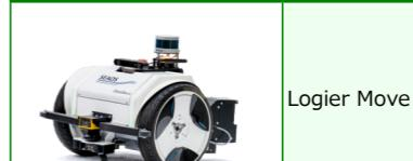
自動フッキング・切離しにより車両搬送の全自動化・無人化を実現する自律走行搬送ロボット。セグで自己位置と周辺を認識し安全走行。工場・物流倉庫・商業施設で活躍します
